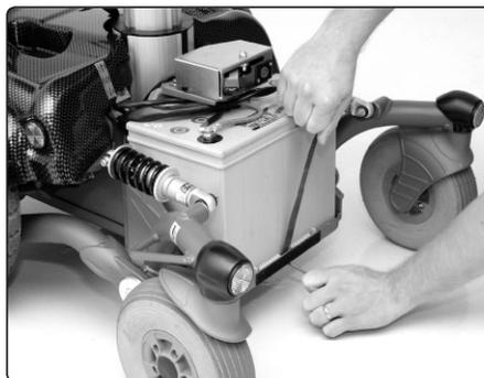
*Die Batterieunterkanten anheben, Batterie herausnehmen*
