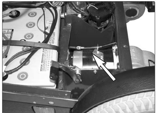
Abb. 28. Entriegelungsdraht Magnetbremse.
