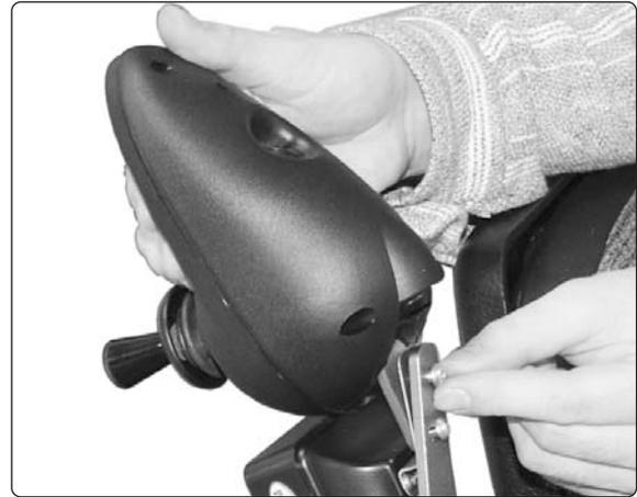
Abb. 42. Halterung von Steuerung und Knopfkasten.
