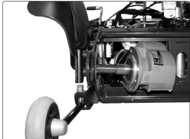
Abb. 30. Ausbau Antriebsmotor.
