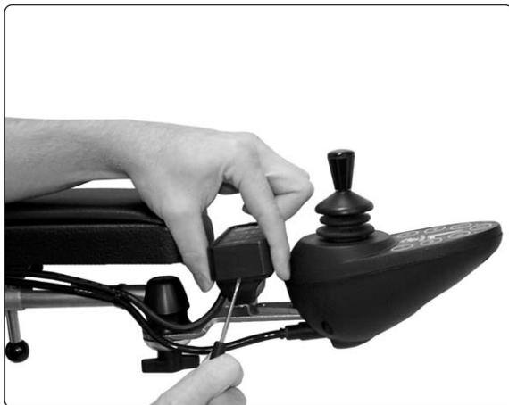
Abb. 44. Deckel des Knopfkastens abnehmen.
