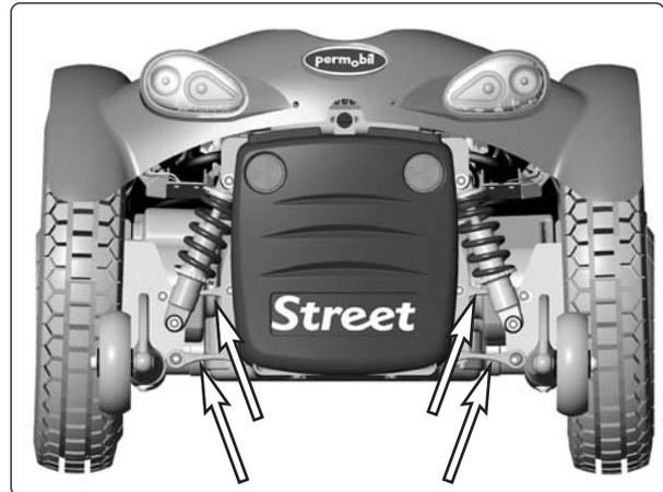
An der Rollstuhlhinterseite befinden sich vier Parallelstreben.
