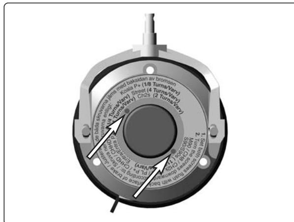
Die Bremseinstellung erfolgt mit Hilfe der beiden Justierschrauben.
