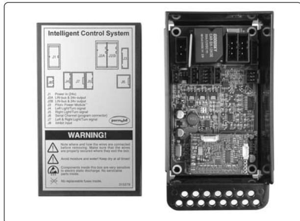
ICS Master Module mit demontiertem Deckel.
