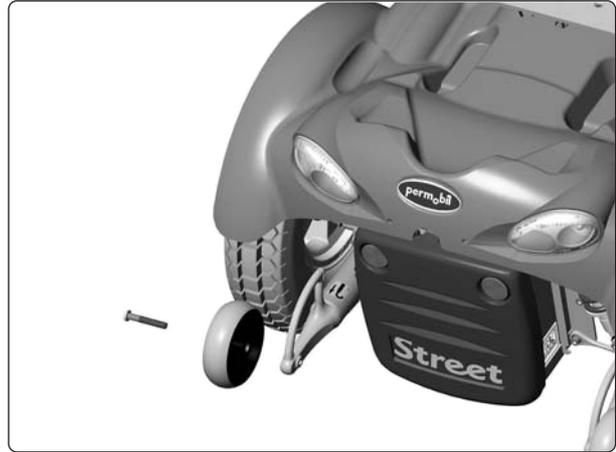
Die Stützräder sind mit jeweils einer Schraube montiert.
