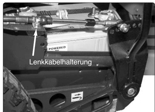
Einbau im Chassis, Steuerknüppel
