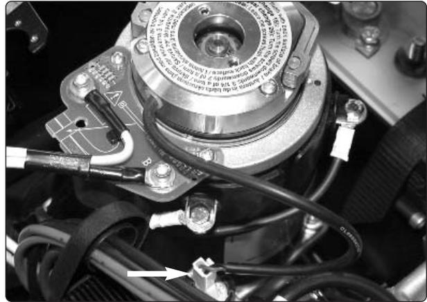
*Anschlußkabel der Magnetbremse*
