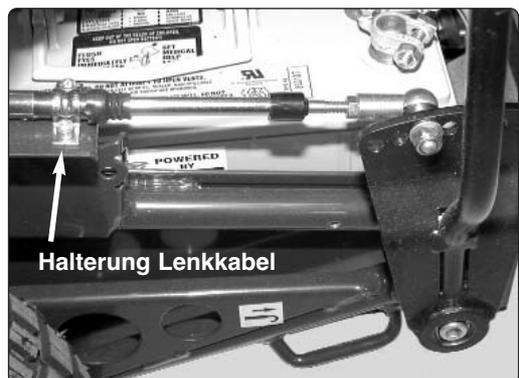
Einbau im Chassis, Steuerknüppel
