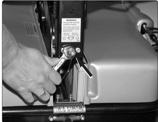
Zum Ausfahren gegen den Uhrzeigersinn drehen.
