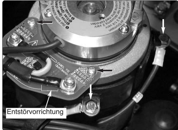
*Kabelanschlüsse im Antriebsmotor*
