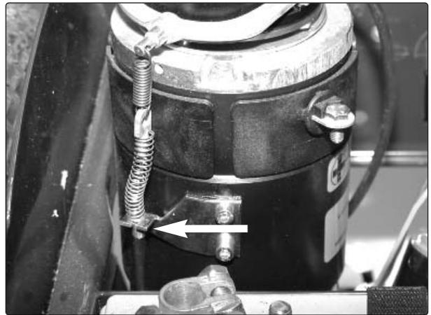
*Befestigung für Bremsentriegelungsdraht*
