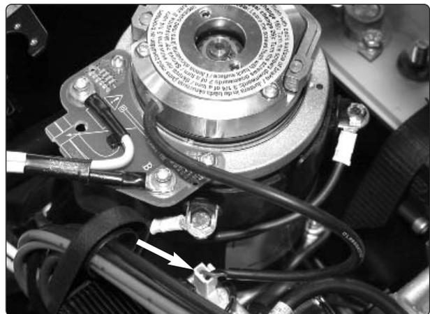
*Anschlußkabel der Magnetbremse*
