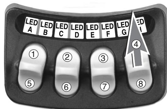
*Einstellungen speichern, indem das Steuerelement 2 Sekunden lang auf Position 8 gehalten wird.*
