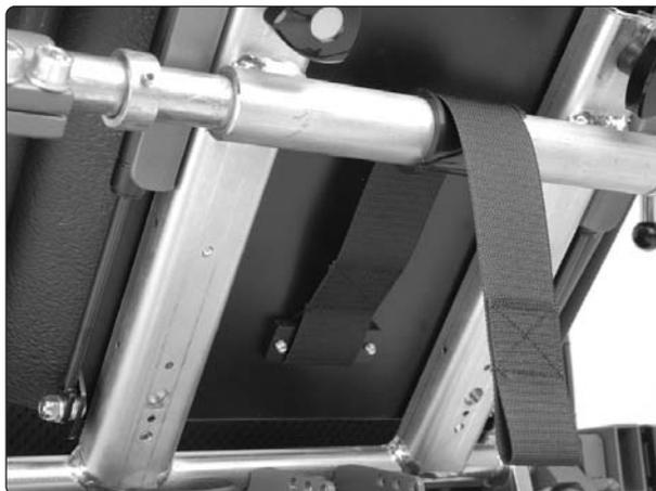
*Neuen Riemen mit der Halterung an der Rückenlehne montieren.*
