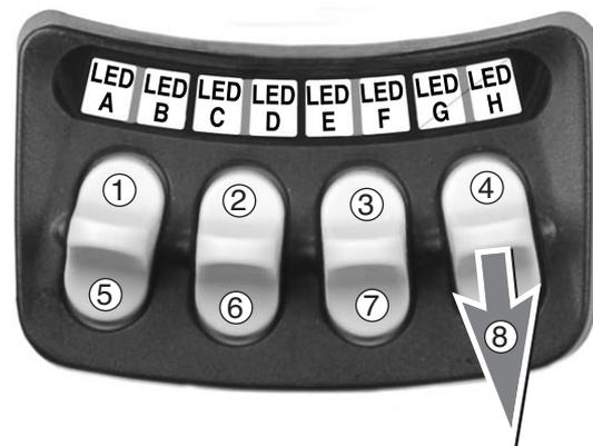
*Einstellungen speichern, indem das Steuerelement 2 Sekunden lang auf Position 8 gehalten wird.*
