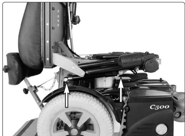
Das Stellgerät für den Beinstützenwinkel ist mit zwei Schrauben befestigt.
