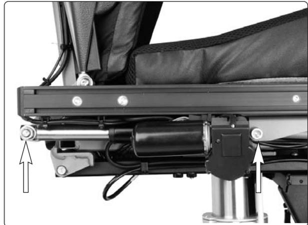
Das Stellgerät für den Rückenlehnenwinkel ist mit zwei Schrauben befestigt.
