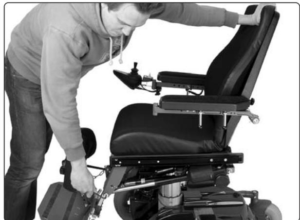
Oberkante der Rückenlehne bei der Demontage des Stellgeräts nach hinten drücken.
