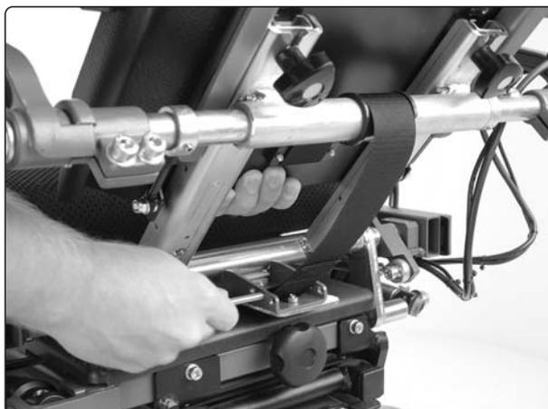
*Rückenlehne vorsichtig anheben bis der Riemen zur unteren Halterung reicht und Splint montieren.*
