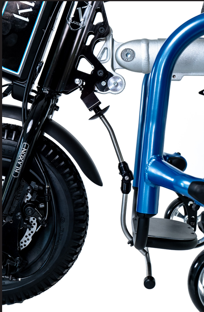
1. Der Ständer passt sich automatisch an den Rollstuhl des Benutzers an und muss beim Ankoppeln oder Parken nicht manuell eingestellt werden, da er bereits in Position ist. Für den Transport im Auto, Flugzeug oder Zug kann er mit einem einfachen Druck entfernt werden.
