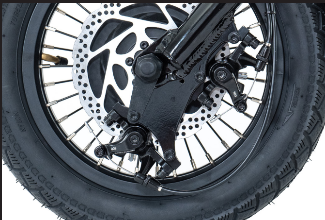
3. Klick-Modelle sind mit Doppelsattel-Scheibenbremsen ausgestattet. *(1)
