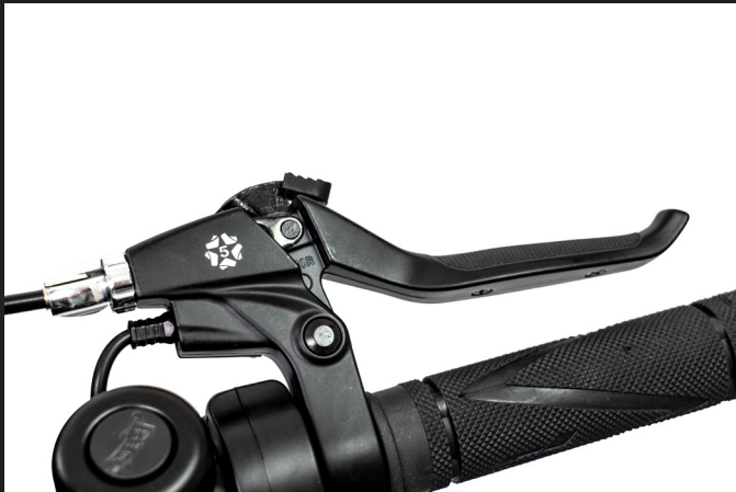
2. Klick verfügt über Feststellbremsen an den Bremshebeln.
