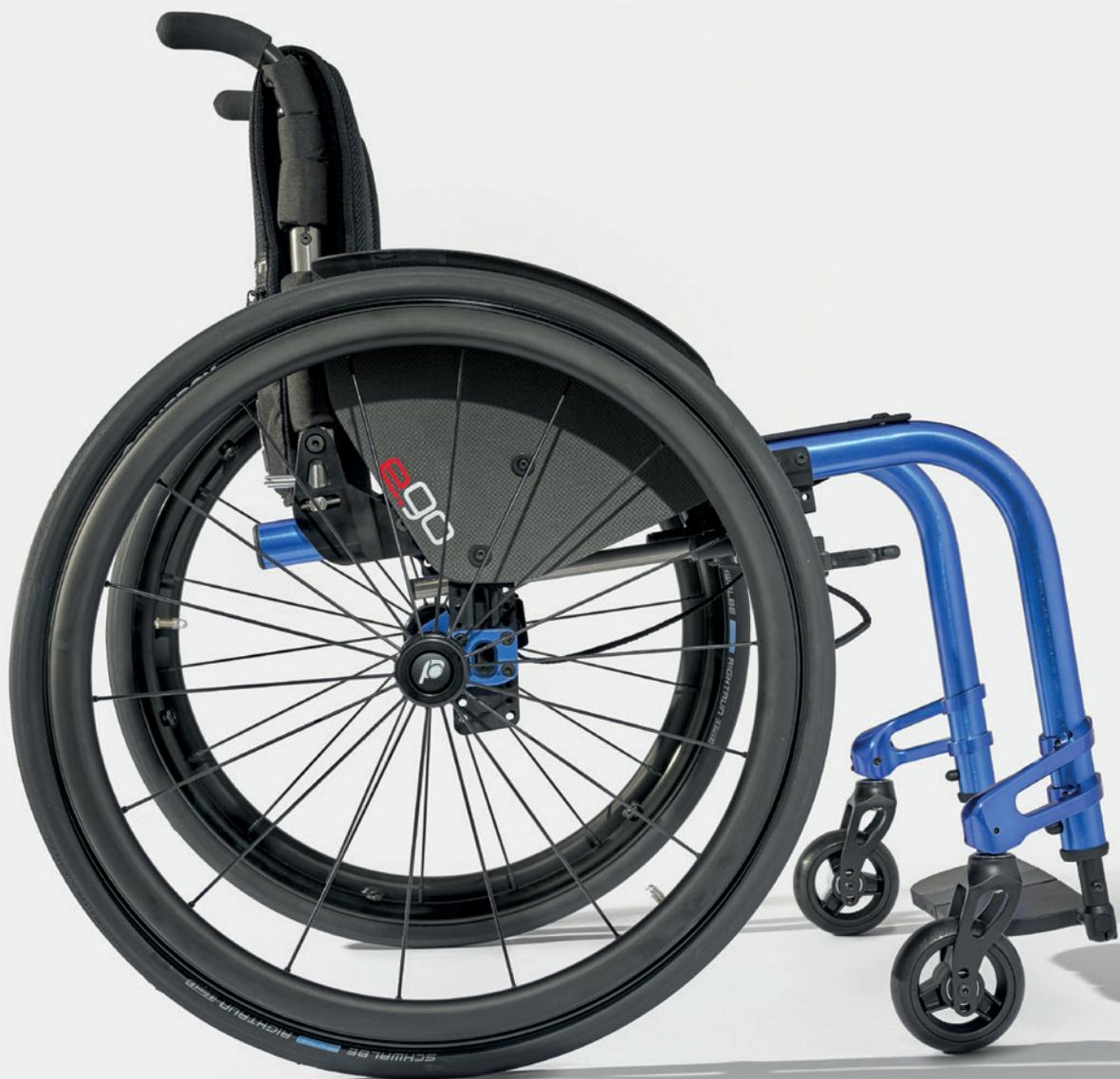
**DE - Wenn Design mit Hochtechnologie zusammentrifft, wird eine brillante Idee zum Leben erweckt: EGO. Ein innovatives, leicht zu bedienendes Faltsystem zusammen mit einer einzigartigen Stabilität und mit einem extrem reduzierten Gewicht. Ovalisierte Rahmenrohre aus einer superleichten Aluminiumlegierung und eine äußerst kompakte Bauform sind nur einige der Charakteristiken dieses Topmodells.**
