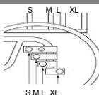
Je kürzer der Radstand desto dynamischer ist das Fahrverhalten und die Kippfreudigkeit des Rollstuhls. Z. B. mit der Stuhlgröße "L" kann die Hinterradposition "M" gewählt werden. Antikipprollen sind in diesem Fall empfohlen. Standardmäßig wird die Position nach Sitzrahmengröße eingestellt.
