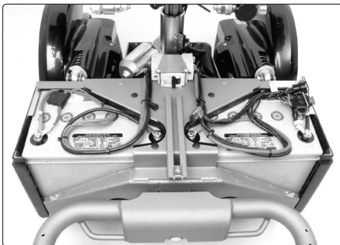
Platzierung der Batterien
