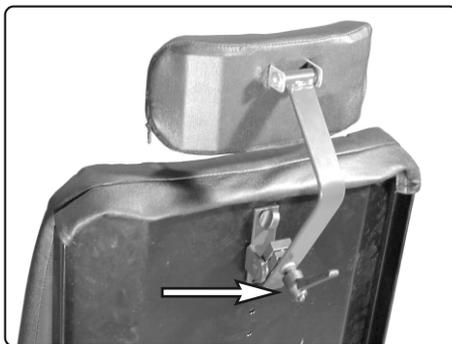
Abb. 54: Feststellhebel
