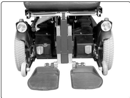
*Abb. 3: Leuchte, Blinker und Reflektoren vorne*
