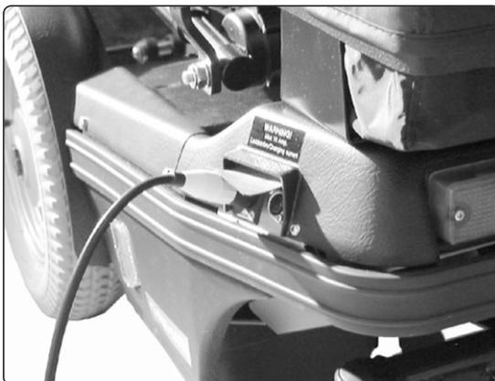
*Abb. 49: Anschluß des Ladesteckers*
