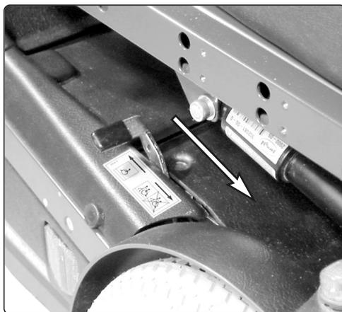
*Abb. 47: Entriegeln der Bremsen*
