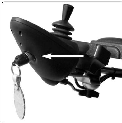
Abb. 10: Buchse mit Schlüsselschalter.
