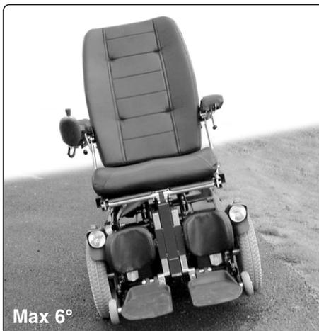
*Abb. 46: Befahren von seitlichen Schrägen*
