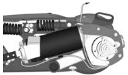
Abbildung 198. Bei Rollstühlen mit Beleuchtung und Blinkern verbinden Sie das Blinkerkabel mit dem Stecker, der mit der vorderen Beleuchtung und dem Blinker gekennzeichnet ist. Positionieren Sie das andere Kabel um das Zahnrad herum und durch den Schlitz oben auf der Abdeckung.
