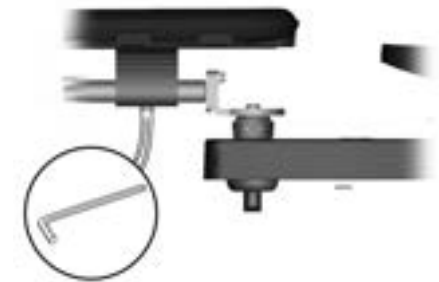
Abbildung 523. Die Position der Schraube auf den früheren Modellen des Parallelpulthalters.
