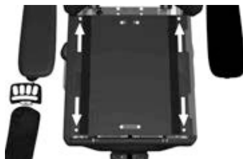
Abbildung 495. Die Sitzplatten werden mithilfe von zwei Schrauben an der Hinterkante und zwei Schnellbefestigungsklemmen an der Vorderseite befestigt.
