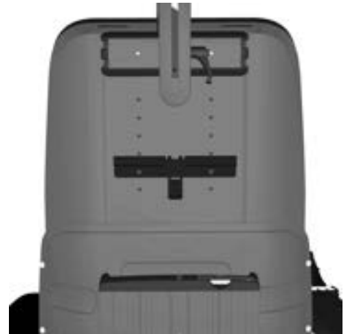
Abbildung 502. Der Rückenlehnen-Verriegelungsmechanismus ist für die Rückenlehnenhöhe 645 mm angebracht.
