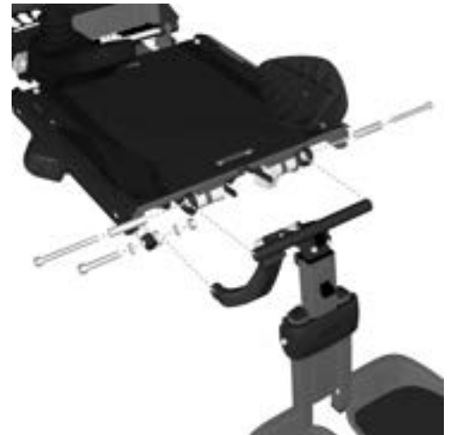
Abbildung 121. Die Beinstütze ist mit zwei Schrauben und Abstandsstücken befestigt. Die vordere Halterung der Stellvorrichtung wird von einer Schraube und Sicherungsmutter gehalten.
