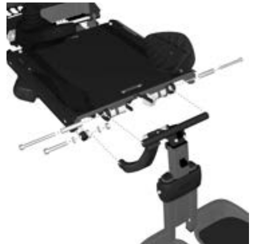
Abbildung 120. Die Beinstütze ist mit zwei Schrauben und Abstandsstücken befestigt. Die vordere Halterung der Stellvorrichtung wird von einer Schraube und Sicherungsmutter gehalten.
