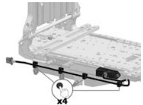
Abbildung 332. Das Kabel des Sitzneigungsmotors ist mit vier Kabelhalterungen montiert (Sitztiefe 545 – 570 mm).
