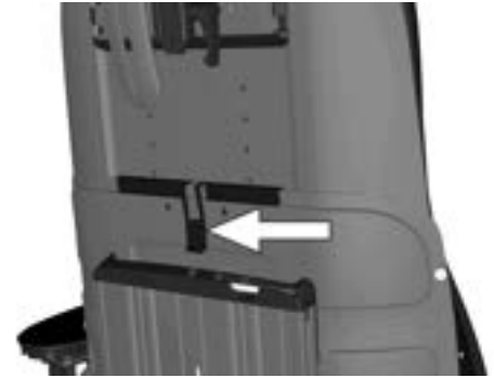
Abbildung 30. Der obere Abschnitt der Rückenlehne ist mit einem Verriegelungsmechanismus gesichert.
