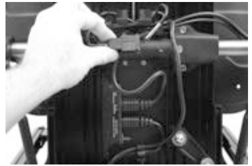
Abbildung 20. Verbinden Sie das R-net-Kabel vom Kontaktblock auf der Rückseite der Rückenlehne.
