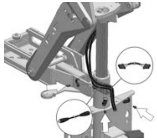
Abbildung 473. Die Buskabel sind am Pfosten mithilfe von drei Kabelhalterungen befestigt.
