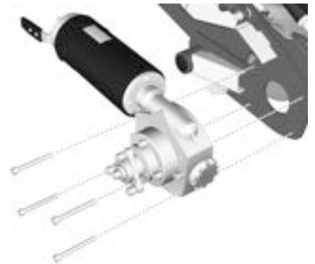
Abbildung 376. Anbringen oder Ausbauen des Antriebsmotors.
