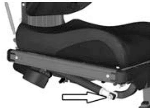
Abbildung 217. Befestigungsschraube der Stellvorrichtung.
