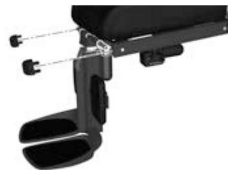
Abbildung 142. Montieren Sie wieder die Vorderenden der UniTrack-Schienen.
