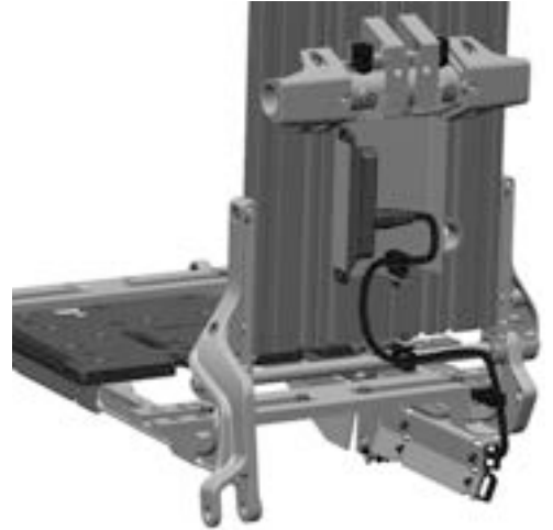
Abbildung 464. Buskabel R-net ist mit dem Verbinderblock verbunden und in zwei Kabelbefestigungen auf der Rückseite der Rückenlehne angebracht.
