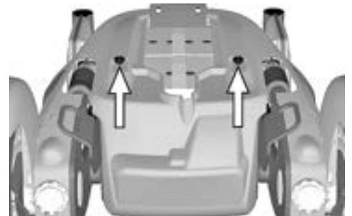
Abbildung 353. Die Abdeckungen des Fahrgestellkastens sind mit zwei Knäufen gesichert.
