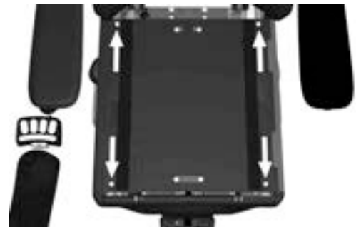
Abbildung 25. Die Sitzplatten werden von vier Schrauben gehalten.
