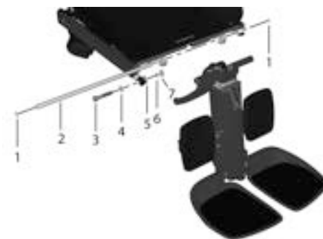
Abbildung 140. Die Beinstütze wird mit einer Achse (2) mit einem Sicherungsring (1) auf der linken und rechten Seite der Beinstütze befestigt. Die vordere Halterung der Stellvorrichtung wird von einer Schraube (3), Unterlegscheibe (4) und Distanzscheibe (5) und Sicherungsmutter (7) gehalten.
