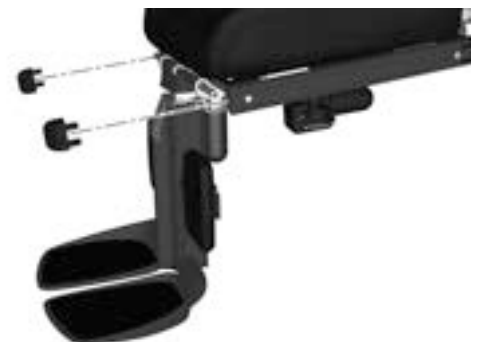
Abbildung 139. Entfernen Sie die Vorderenden der UniTrack-Schienen.
