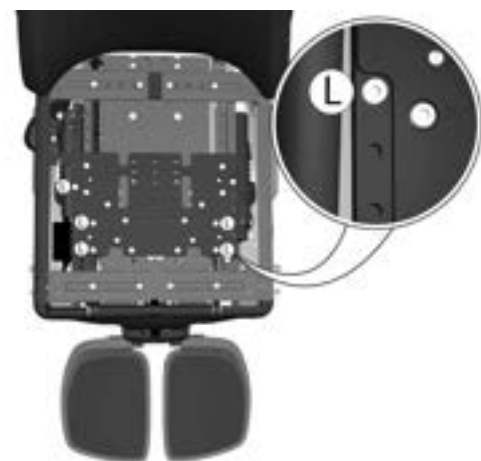
Abbildung 496. Die Position des vorderen Sitzrahmenabschnitts (Beinstützenposition) ist mit fünf Schrauben festgelegt. Sie sind mit dem Buchstaben L markiert.
