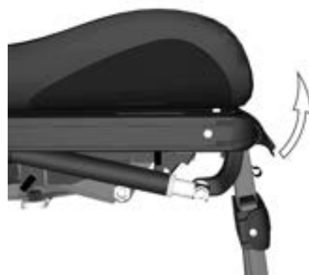
Abbildung 131. Heben Sie die obere Abdeckung der Beinstütze hoch.
