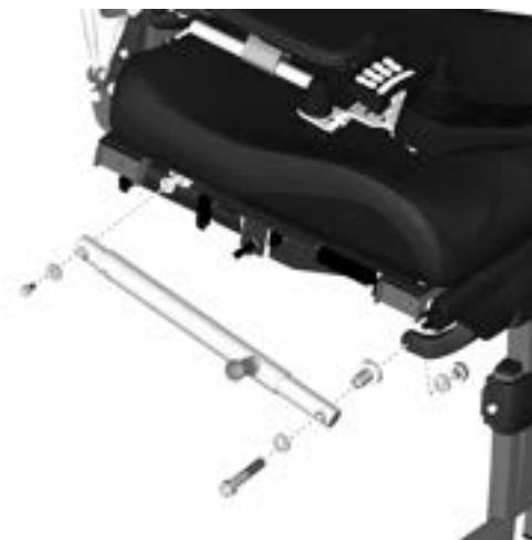
Abbildung 145. Die manuelle Einstellungseinheit der Beinstütze ist mit zwei Schrauben befestigt.
