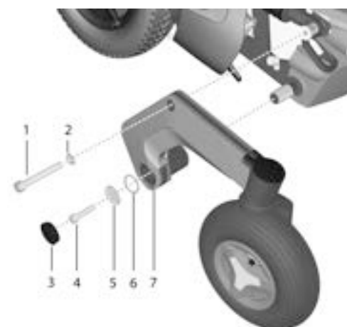
Abbildung 440. Anbringen des hinteren Gelenkarms.
