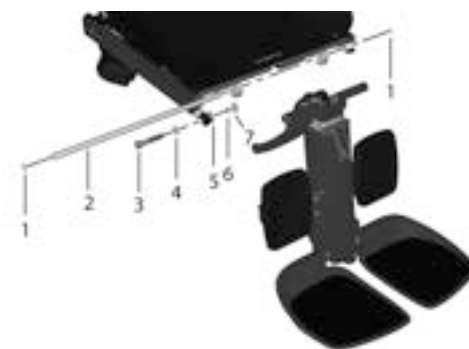
Abbildung 141. Die Beinstütze wird mit einer Achse (2) mit einem Sicherungsring (1) auf der linken und rechten Seite der Beinstütze befestigt. Die vordere Halterung der Stellvorrichtung wird von einer Schraube (3), Unterlegscheibe (4) und Distanzscheibe (5) und Sicherungsmutter (7) gehalten.
