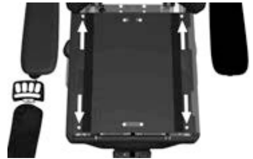
Abbildung 492. Die Sitzplatten werden mithilfe von zwei Schrauben an der Hinterkante und zwei Schnellbefestigungsklemmen an der Vorderseite befestigt.
