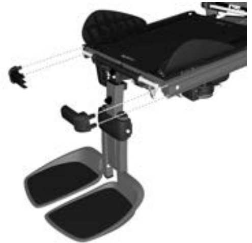
Abbildung 119. Entfernen Sie die Vorderenden der UniTrack-Schienen.
