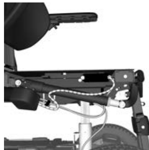
Abbildung 125. Stellvorrichtungverkabelung, gilt für LINAK und REAC.
