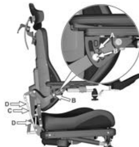
Abbildung 512. Einstellung von Armlehnenhöhe und -winkel.
