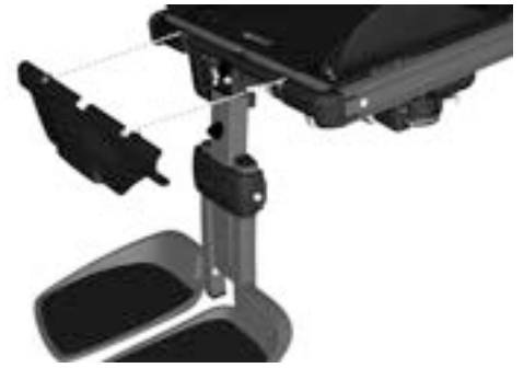
Abbildung 118. Demontieren Sie die obere Abdeckung der Beinstütze, indem Sie sie vorsichtig gerade herausziehen.
