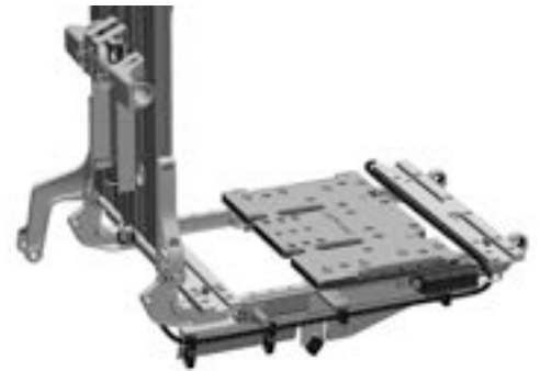
Abbildung 465. Das Neigemotorkabel ist mit vier Kabelbefestigungen angebracht.
