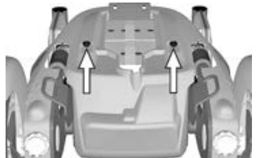
Abbildung 371. Die Abdeckungen des Fahrgestellkastens sind mit zwei Knäufen gesichert.
