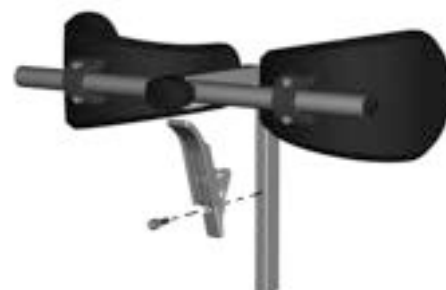
Abbildung 543. Einstellen der Höhe der Kniestütze.
