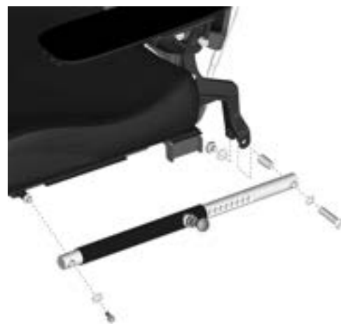
Abbildung 81. Die manuelle Einstellungseinheit der Rückenlehne ist mit zwei Schrauben befestigt.
