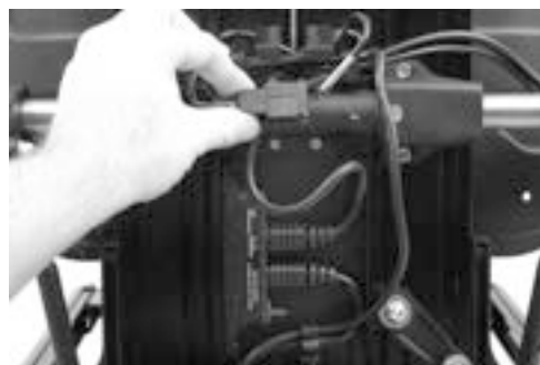
Abbildung 225. Trennen Sie das R-net-Kabel vom Kontaktblock auf der Rückseite der Rückenlehne.
