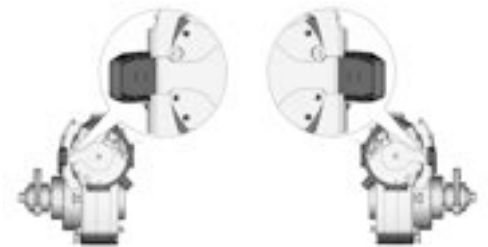
Abbildung 423. Der Bremsenentriegelungshebel besitzt eine Endpositionsschraube, die in verschiedenen Positionen angebracht ist. Die genaue Position hängt davon ab, ob die Magnetbremse am rechten oder linken Antriebsmotor am Fahrgestellkasten angebracht ist.
