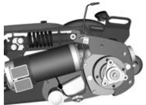
Abbildung 199. Bei Rollstühlen nur mit Beleuchtung (keine Blinker) positionieren Sie das Adapterkabel zwischen dem Antriebsmotor und Zahnrad und durch den Schlitz oben auf der Abdeckung.
