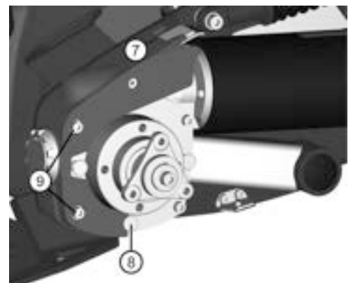
Abbildung 197. Die Triebkranz-Abdeckung ist mit einem Klettverschluss an der Oberseite (7) und einem Befestigungspunkt an der Unterseite (8) angebracht.
