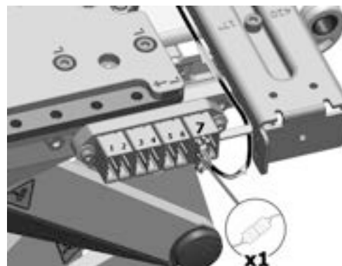
Abbildung 466. Das ICS-Buskabel befindet sich an der siebten Position des Verbinderblocks.
