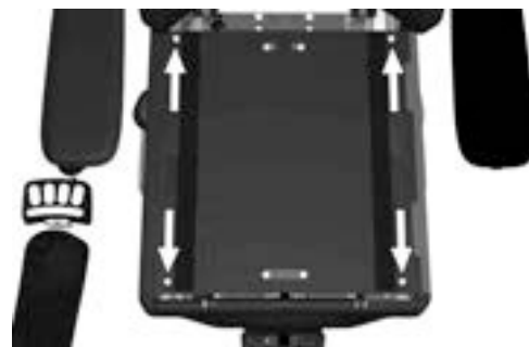
Abbildung 499. Die Sitzplatten werden mithilfe von zwei Schrauben an der Hinterkante und zwei Schnellbefestigungsklemmen an der Vorderseite befestigt.
