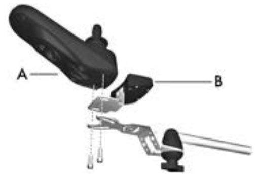
Abbildung 459. Das Steuerpult ist mit zwei Schrauben auf dem drehbaren Pulthalter befestigt.
