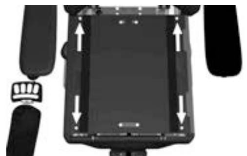
Abbildung 26. Die Sitzplatten werden von vier Schrauben gehalten.
