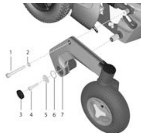
Abbildung 439. Ausbauen des hinteren Gelenkarms.
