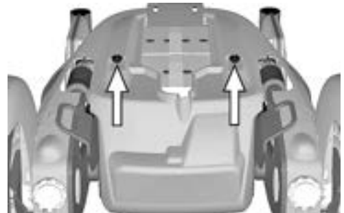
Abbildung 188. Die Abdeckungen des Fahrgestellkastens verfügen über zwei Knäufe.
