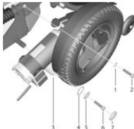
Abbildung 441. Ausbauen des vorderen Gelenkarms.
