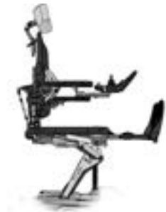
Abbildung 309. Bewegen Sie den Sitz in die horizontale Position.
