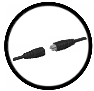
Abbildung 104. Die Kabelverbindung des Steuerpults befindet sich in den meisten Fällen unter der Armlehne.
