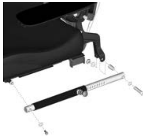
Abbildung 80. Die manuelle Einstellungseinheit der Rückenlehne ist mit zwei Schrauben befestigt.
