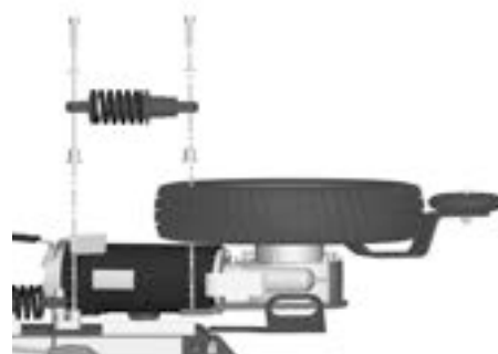
Abbildung 437. Anbringen oder Ausbauen des vorderen Stoßdämpfers.
