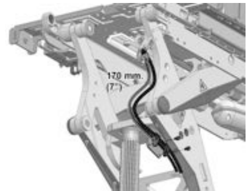
Abbildung 469. Die Länge der Kabelschleife zwischen den Kabelhalterungen auf dem oberen und unteren Teil der AP-Höhenverstellung muss 170 mm betragen.
