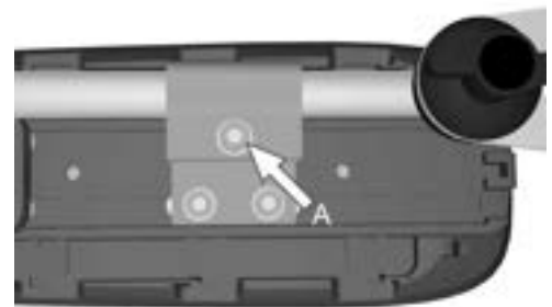
Abbildung 514. Einstellungsschraube für die Pulthalterlänge
