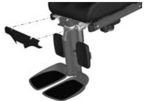
Abbildung 138. Demontieren Sie die obere Abdeckung der Beinstütze, indem Sie sie vorsichtig gerade herausziehen.
