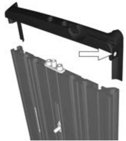
Abbildung 90. Die Endabdeckung des Rückenlehnenprofils ist mit einer Schraube auf der linken und einer Schraube auf der rechten Seite gesichert.
