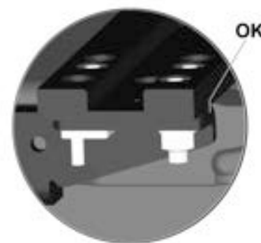
Abbildung 53. Schließt die hintere Kante der Stellvorrichtungshalterung mit der Sitzstange ab, bedeutet dies, dass nicht ausgelöst wurde.
