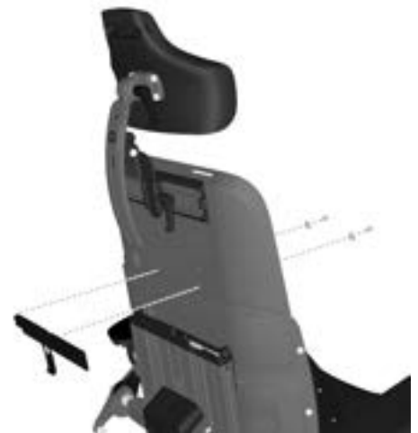
Abbildung 501. Der Verriegelungsmechanismus ist mit zwei Schrauben befestigt.
