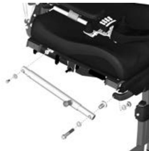
Abbildung 146. Die manuelle Einstellungseinheit der Beinstütze ist mit zwei Schrauben befestigt.
