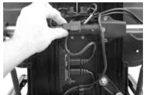
Abbildung 85. Trennen Sie das R-net-Kabel vom Kontaktblock auf der Rückseite der Rückenlehne.
