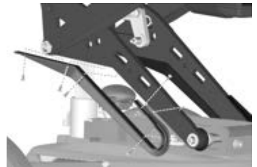
Abbildung 336. Der Klemmschutz ist mit fünf Schrauben montiert.
