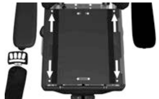
Abbildung 205. Die Sitzplatten werden von vier Schrauben gehalten.
