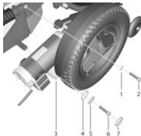
Abbildung 442. Anbringen des vorderen Gelenkarms.
