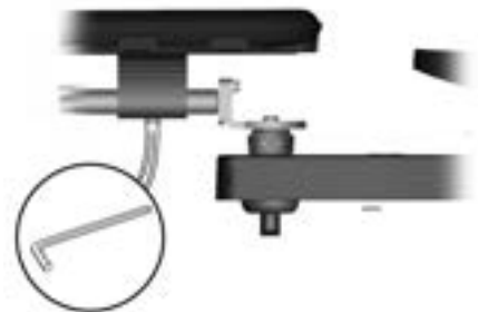
Abbildung 106. Die Position der Schraube auf dem früheren Modell des Parallelpulthalters und dem drehbaren Pulthalter.
