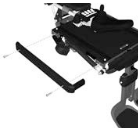
Abbildung 498. Die UniTrack-Schienen werden mit jeweils zwei Schrauben befestigt.
