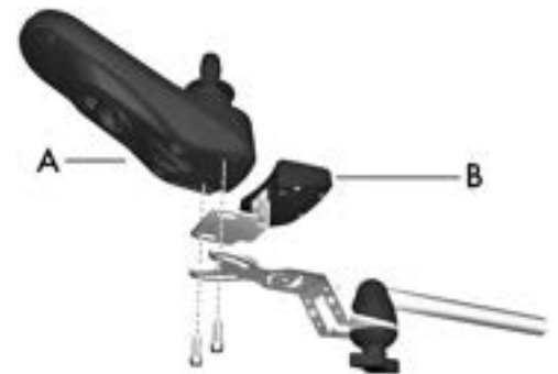
Abbildung 461. Das Steuerpult ist mit zwei Schrauben auf dem drehbaren Pulthalter befestigt.
