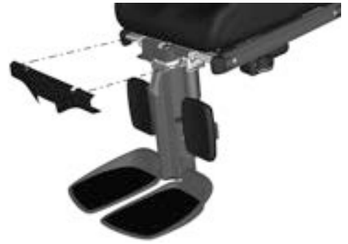
Abbildung 143. Montieren Sie die obere Abdeckung der Beinstütze. Drücken Sie dabei die Halterungen an den Befestigungsschrauben/Abstandshaltern der Beinstütze an Ort und Stelle.
