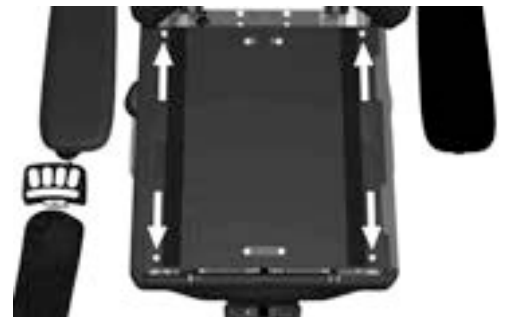
Abbildung 218. Die Sitzplatten werden von vier Schrauben gehalten.
