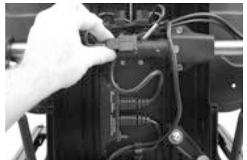
Abbildung 99. Verbinden Sie das R-Net-Kabel im Kontaktblock auf der Rückseite der Rückenlehne.
