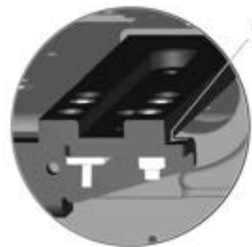
Abbildung 54. Ragt die Stellvorrichtungshalterung hinten heraus, wurde die Funktion ausgelöst. Die Halterung muss dann erneut montiert werden. Bestimmte Komponenten sind auszutauschen.
