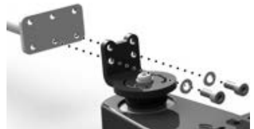
Abbildung 535. Die zwei Schrauben mit Unterlegscheiben auf den früheren Modellen des Parallelpulthalers.
