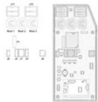
Abbildung 249. Verbinden Sie das Kabel entweder mit dem Anschluss J11 oder J12.
