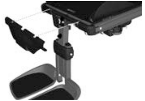
Abbildung 207. Demontieren Sie die obere Abdeckung der Beinstütze, indem Sie sie vorsichtig gerade herausziehen.
