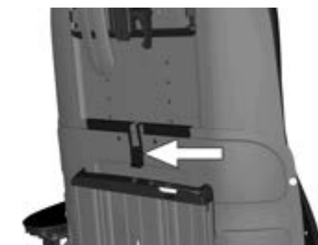
Abbildung 35. Ausbau oder Montage des oberen Abschnitts der Rückenlehne.
