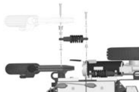
Abbildung 438. Anbringen oder Ausbauen des hinteren Stoßdämpfers.
