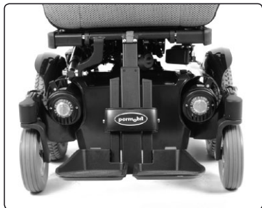
A. Korrekt ausgerichtete Vorderräder
