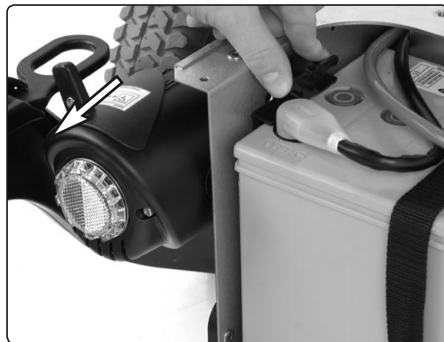
Bei einigen Modellen sind die Batterien mit Batterieschlössern gesichert.
