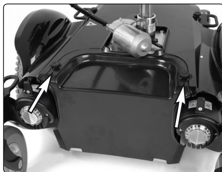
Die vordere Fahrgestellabdeckung ist mit zwei Griffen befestigt.
