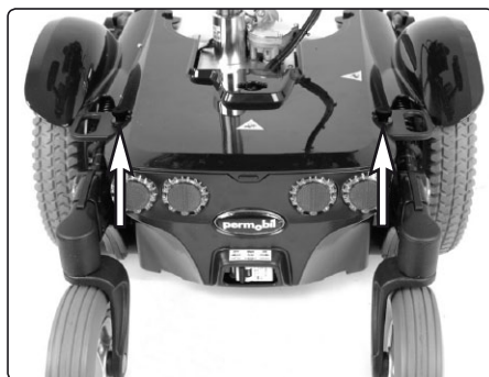
Die obere Fahrgestellabdeckung ist mit zwei Griffen befestigt.
