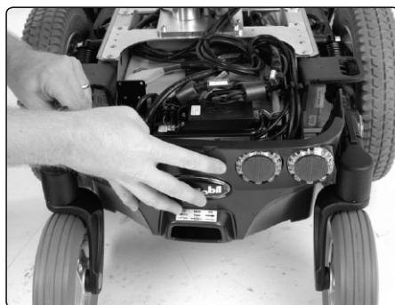
Hintere Fahrgestellabdeckung demontieren.
