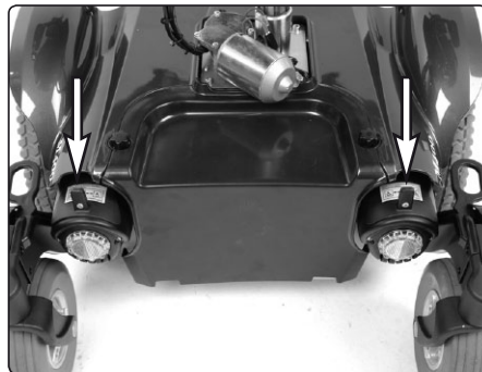
Die beiden Bremsentriegelungsvorrichtungen des Rollstuhls.
