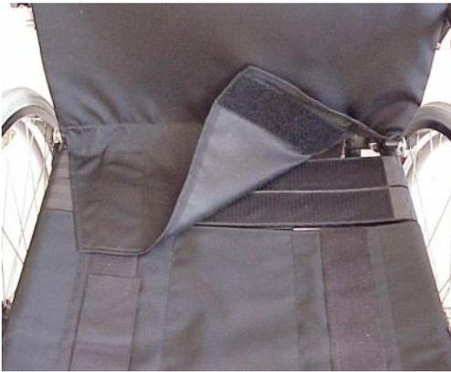
Die Spannung des Rückenpolsters kann individuell mit den darunterliegenden Klettguten angepasst werden. Für eine aufrechtere Sitzposition können sie mehr gespannt, für eine bessere Rückenunterstützung weniger gespannt werden.
