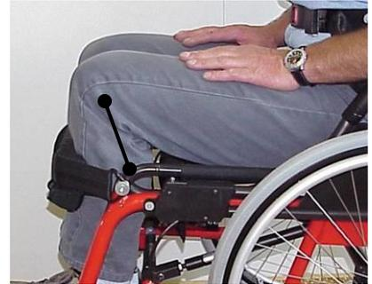
Kniehalterbefestigungsschraube hinter dem Knie-Drehpunkt
