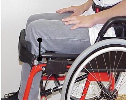
Kniehalterbefestigungsschraube genau über dem Knie-Drehpunkt
