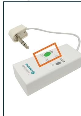
Wenn die grüne LED kurz gedrückt wird werden für 15min alle Alarme gesperrt
