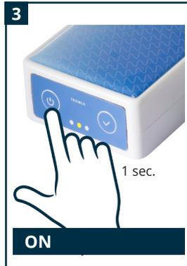
**Schalten Sie den Sender ein durch einmaliges drücken der Taste - Licht blinkt kurz weiß**
