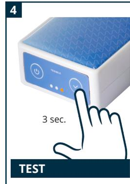
**Kontrollieren Sie das System durch einen Funktionstest. Drücken Sie 3 Sekunden die Taste - Licht blinkt orange.**
