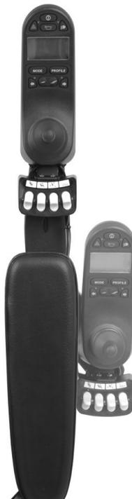
*Die Steuerung kann auch schräg nach hinten zur Seite geschoben werden, um das Ein- und Aussteigen zu erleichtern.*
