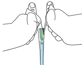
Peelverpackung am Konnektorende öffnen.
