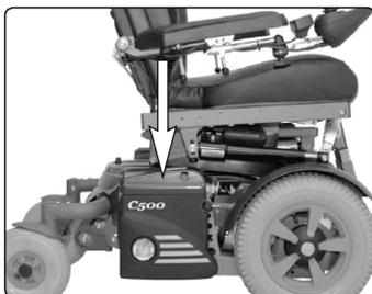
Die Ladesicherung befindet sich unter der hinteren Fahrgestellabdeckung
