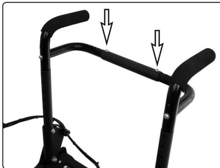
*Die Breitereinstellung des Rückenlehnenrahmens wird mit zwei Schrauben fixiert.*
