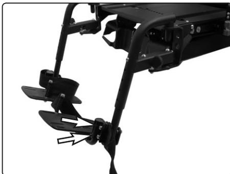
*Die Fußplatte ist mit zwei Schrauben befestigt.*
