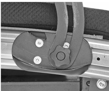
Abb. 32. Rückenlehne nach vorne klappen, bis die Schrauben der Halterung zugänglich sind.
