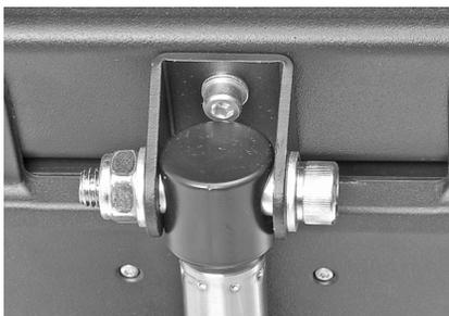
Abb. 54. Bolzen des Stellgeräts demontieren, sodass die Rückenlehne nach vorne geklappt werden kann.
