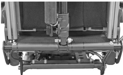
Abb. 44. Schrauben für die Sitzbreite an der unteren Stellgeräthalterung.
