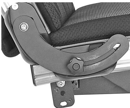
Abb. 9. Schraubgriff für die Einstellung der Rückenlehnenneigung.
