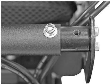
Abb. 45. Die untere Stellgeräthalterung verfügt über Schraublöcher, die denen am Sitzrahmen entsprechen.
