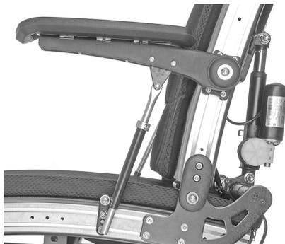
Abb. 27. Hohe Armlehnenposition mit gewendeter Befestigung am Sitzrahmen.
