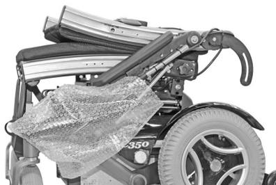
Abb. 53. Rückenlehne für den Transport auf die Sitzpolsterung gelegt und Fußplatten eingeklappt. Hier ist zum Schutz vor Scheuerstellen ein Plastiküberzug über das Steuerpult gezogen.
