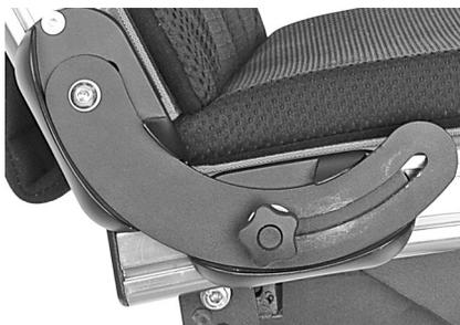
Abb. 52. Sperrgriff lösen und Rückenlehne vom Rückenlehnengelenk abnehmen.
