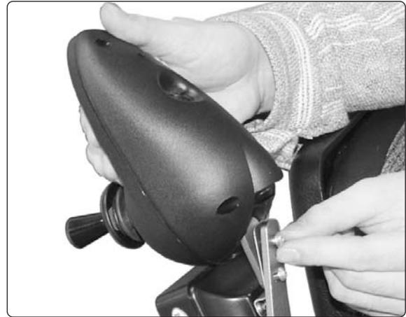
*Halterung der Steuerung und des Schaltkastens.*
