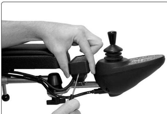
*Demontage des Deckels des Schaltkastens.*
