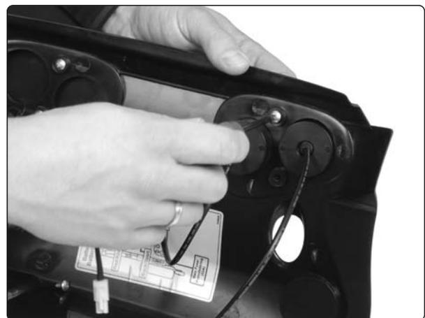
*Die hinteren Lampen sind mit je zwei Schrauben befestigt.*
