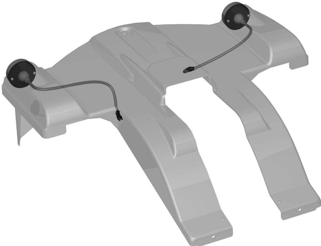
*Die hinteren Lampen sind mit je zwei Schrauben befestigt.*
