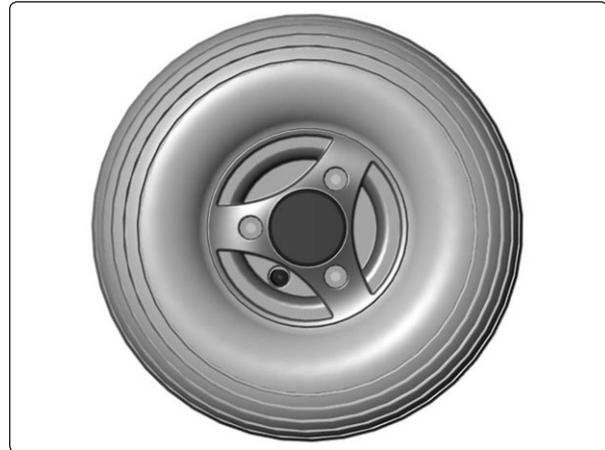
Einfüllventil des Hinterrades.
