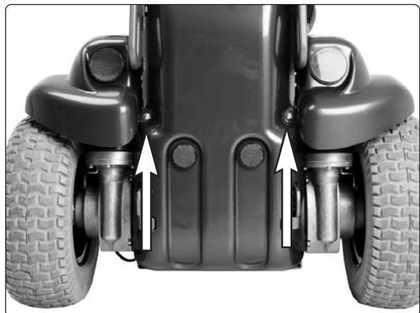
*Die Fahrgestellabdeckung ist mit zwei Schrauben befestigt.*
