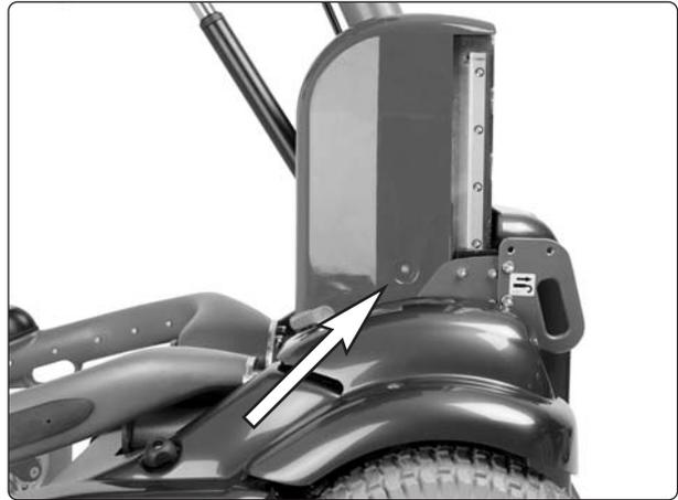
*Befestigungsschraube an der linken Seite der Abdeckung.*
