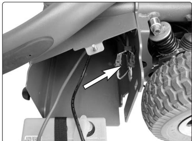
*Kabelkontakt der hinteren Beleuchtungskabel.*
