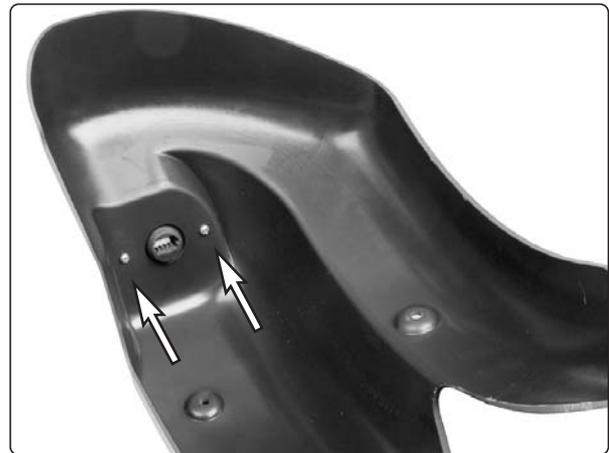
*Die Leuchte ist mit zwei Schrauben an der Innenseite des hinteren Kotflügels befestigt.*
