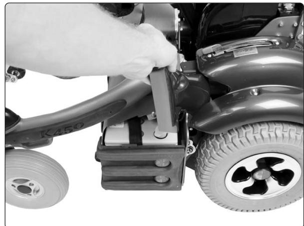
*Demontage/Montage der oberen Batterieabdeckung.*
