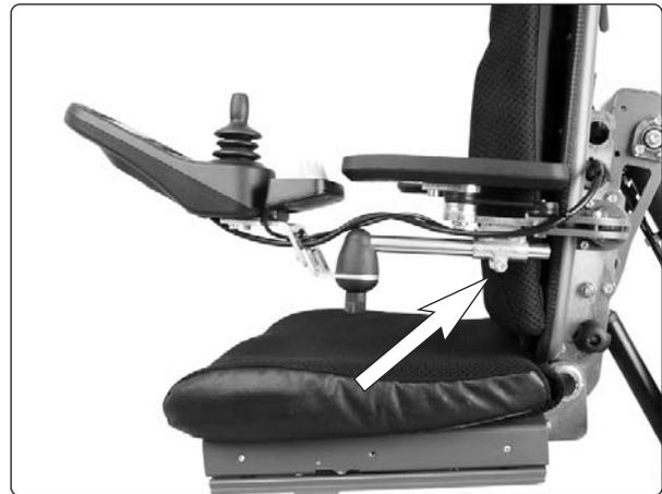
*Die Position der Steuerpulhalterung ist mit einer Schraube fixiert.*
