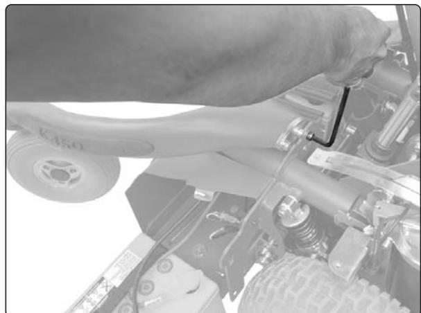
*Demontage der Befestigungsschraube des Tragarms an der Hinterkante.*
