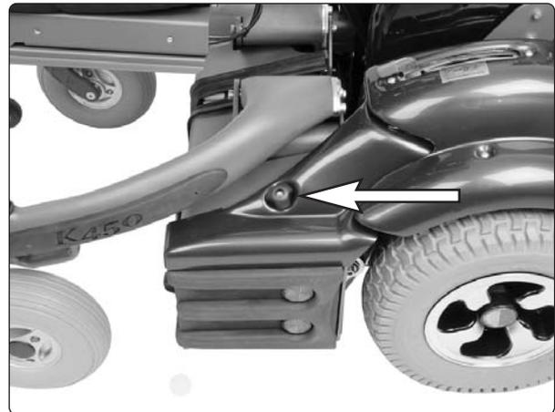
*Die obere Batterieabdeckung ist mit einem Befestigungsgriff an der Oberseite der Abdeckung montiert.*
