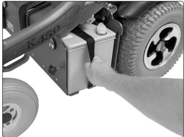
Batterie aus dem Fahrgestell heben/ziehen.
