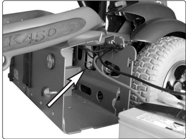
*Der Federungsmechanismus ist mit je zwei Schrauben an beiden Seiten des Fahrgestells befestigt.*
