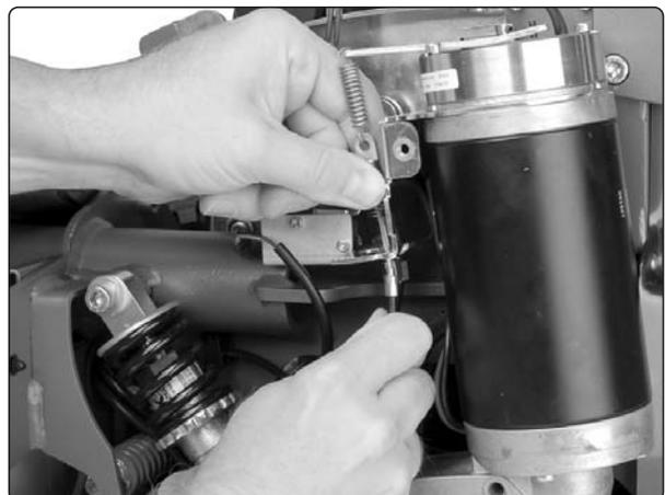
Seilhülle nach unten ziehen und Seil durch die Führung der Seilhalterung herausführen.
