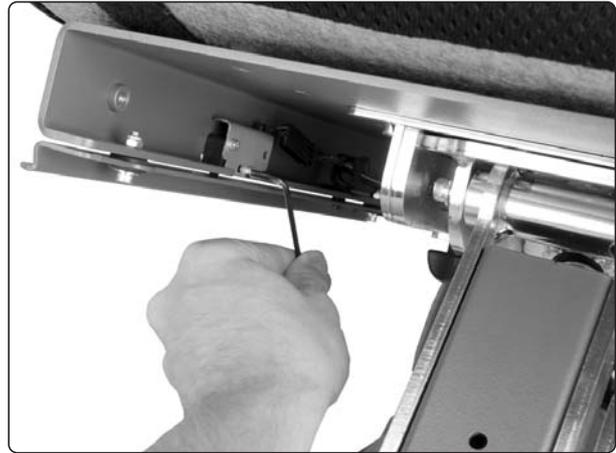
*Der Klemmschutzgeber ist mit zwei Schrauben befestigt.*
