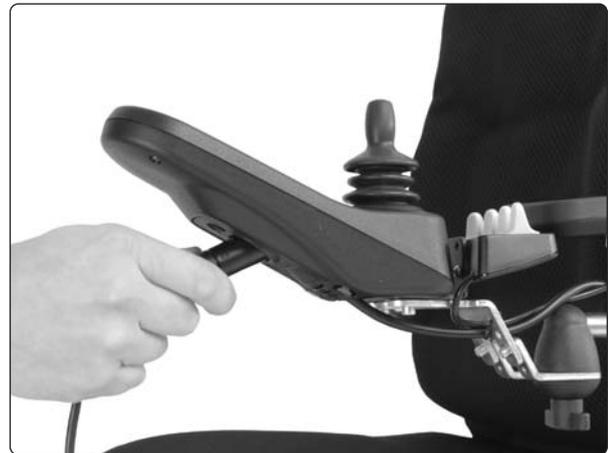
*Anschließen des Notbetätigungskabels an die Ladesteckdose.*
