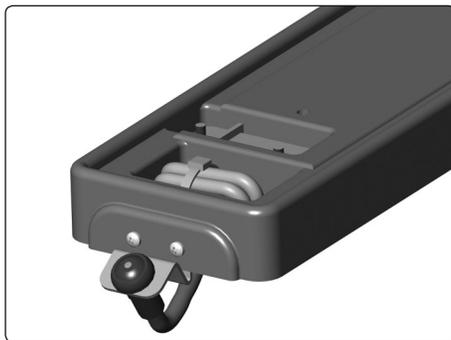
*Schalterkabel und Anschlusschalter mit Kabelbindern in die Armlehne montieren.*
