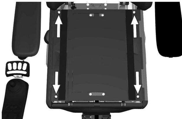
Abbildung 136. Die Sitzplatten sind mit vier Schrauben befestigt.
