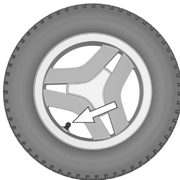
Abbildung 35. Luftventil am Antriebsrad.
