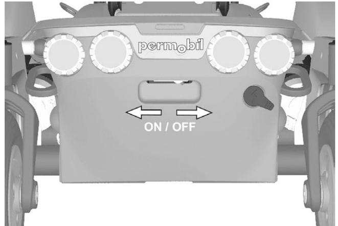
Abbildung 20. Hauptsicherung
