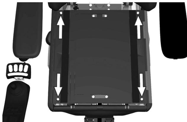
Abbildung 195. Die Sitzbleche sind mit zwei Schrauben an der Hinterkante und zwei Schnellbefestigungsclips an der Vorderkante befestigt.
