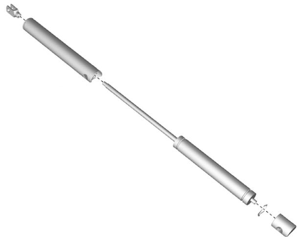
Abbildung 111. Die vordere und hintere Halterung ist an der Gasfeder festgeschraubt.
