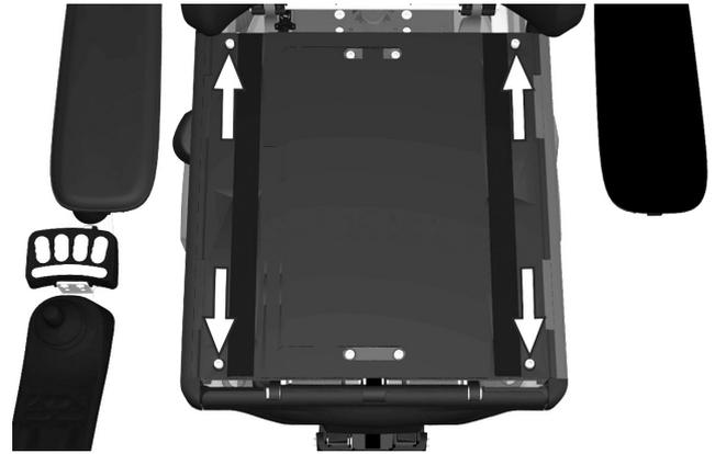
Abbildung 190. Die Sitzbleche sind mit zwei Schrauben an der Hinterkante und zwei Schnellbefestigungsclips an der Vorderkante befestigt.
