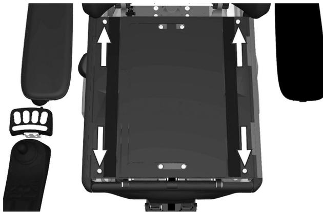
Abbildung 59. Die Sitzplatten sind mit vier Schrauben befestigt.
