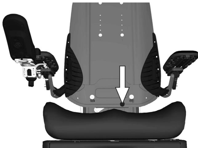
Abbildung 148. Das untere Blech der Rückenlehne wird mit einem Drehgriff fixiert.
