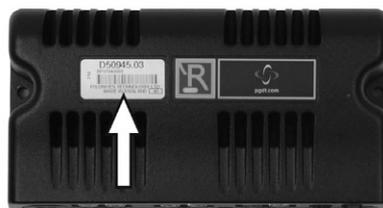
Abbildung 2. Kennnummer Endstufe R-Net.
