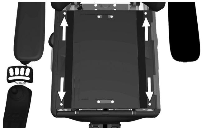
Abbildung 144. Die Sitzplatten sind mit vier Schrauben befestigt.
