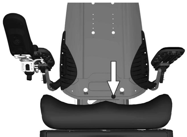
Abbildung 151. Das untere Blech der Rückenlehne wird mit einem Drehgriff fixiert.
