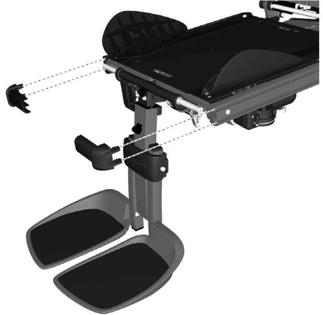
Abbildung 181. Die vorderen Enden der UniTrack-Schienen erneut montieren.
