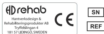
**CE-Kennzeichnung.** Gibt an, dass es sich bei dem Rollstuhl um ein Medizinprodukt mit CE-Kennzeichnung handelt und wer der verantwortliche Hersteller ist. SN steht für Seriennummer, REF für Typennummer.
