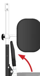
Abb. 31. Hochklappen der Fußplatte
