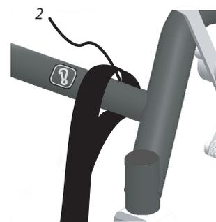
Abb. 51. Spanngurtbefestigung vorn beim Transport
