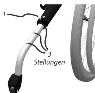
Abb. 8. Die 3 mit dem Schnappschloss einstellbaren Stellungen des Kippschutzes.
