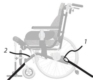
Abb. 48. Rollstuhl mit montierter Spannvorrichtung
