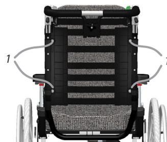
Abb. 18. Muttern zur Höhenverstellung der Rückenlehne.
