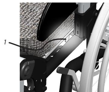
Abb. 20. Der Hebel (1) zur Sitztiefenverstellung befindet sich links unter dem Sitz.
