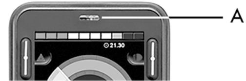
Abbildung 60. Position des IR-Empfängers.
