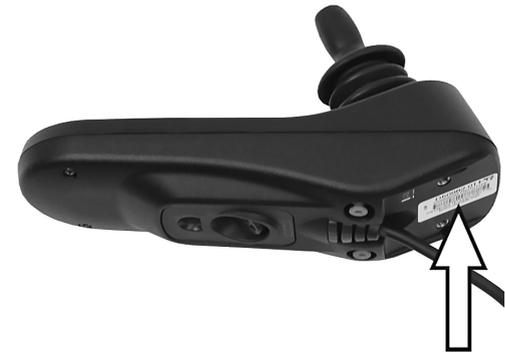
Abbildung 220. Kennnummer des Steuerpults.
