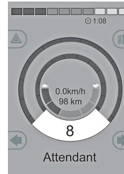
Abbildung 75. Standarddisplay mit Geschwindigkeitsanzeige.
