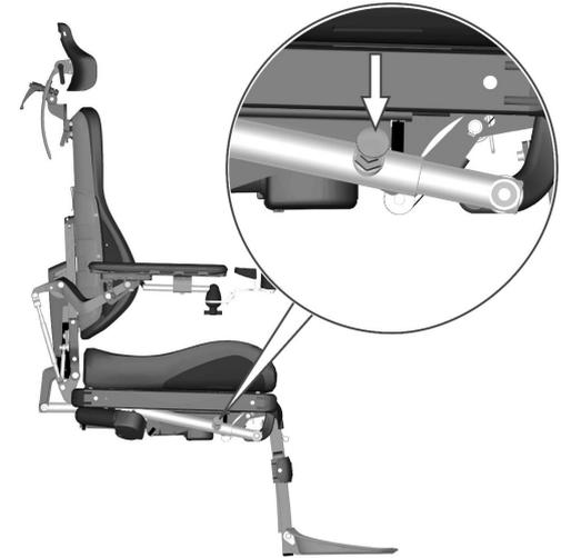
Abbildung 10. Manuelle Einstellung des Beinstützenwinkels.
