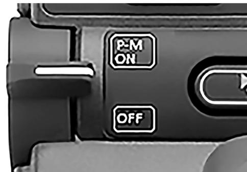
Abbildung 20. Stromversorgung, Modus und Profilhebelschalter.
