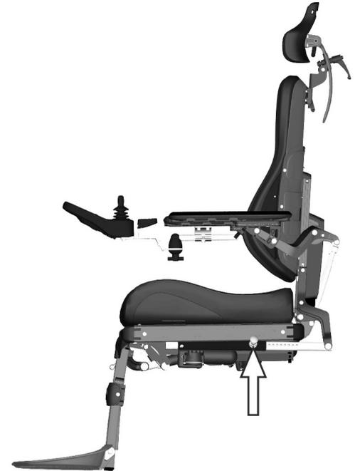
Abbildung 8. Manuelles Klemmrohr für die Rückenlehnenneigung.
