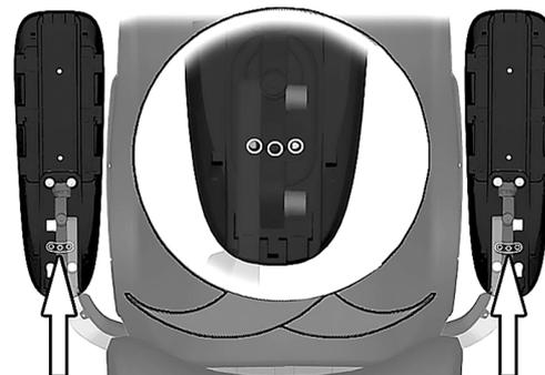
Abbildung 134. Endposition der Armlehenschwenkvorrichtung einstellen.
