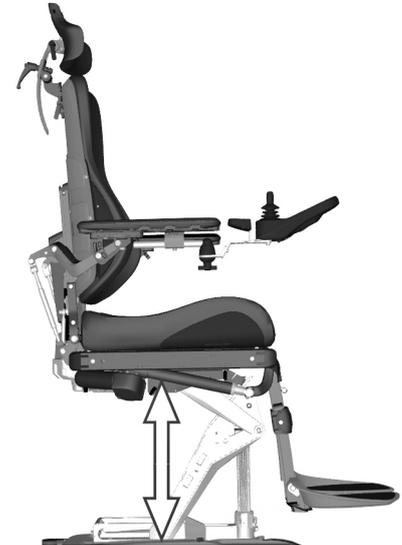
Abbildung 2. Elektrische Sitzhöhenverstellung.
