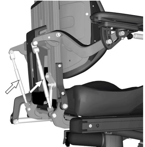
Abbildung 138. Armlehnenwinkel, Einstellleisten.
