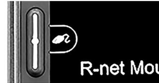
Abbildung 54. Linke Taste für linke Mausklicks.
