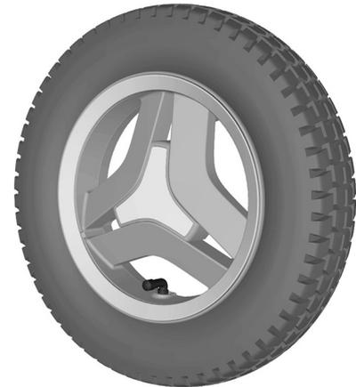
Abbildung 205. Luftventil am Antriebsrad
